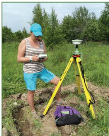
Рис. 4 Измерения координат нового репера «Антоновка»
